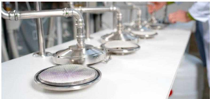
Das Waschwasser wird mit einer Filterkaskade (1,5 mm - 5  $\mu$ m Porengröße) gefiltert und Fasern nach Größe gesammelt und analysiert.
