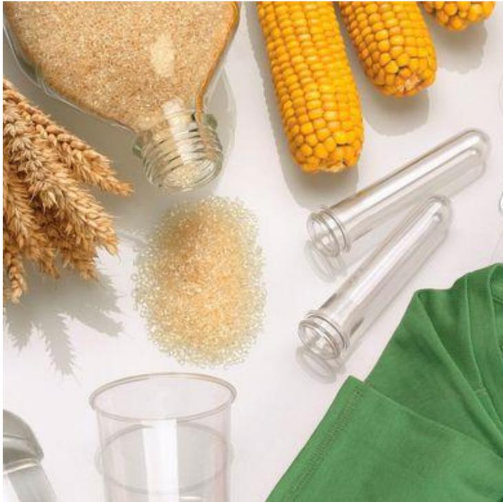
Bild 9: Aus dem biobasierten und biologisch abbaubaren Kunststoff PLA lassen sich verschiedene Produkte herstellen [Bildquelle: thyssenkrupp Industrial Solutions AG]
