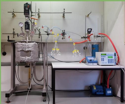
Abb.2: Depolymerisation im Autoklaven im Labormaßstab
