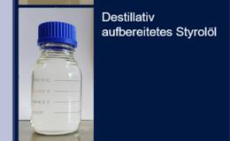
Verweilzeit & Schmelztemperatur sind ausschlaggebend für eine effektive Depolymerisation des Polystyrols
